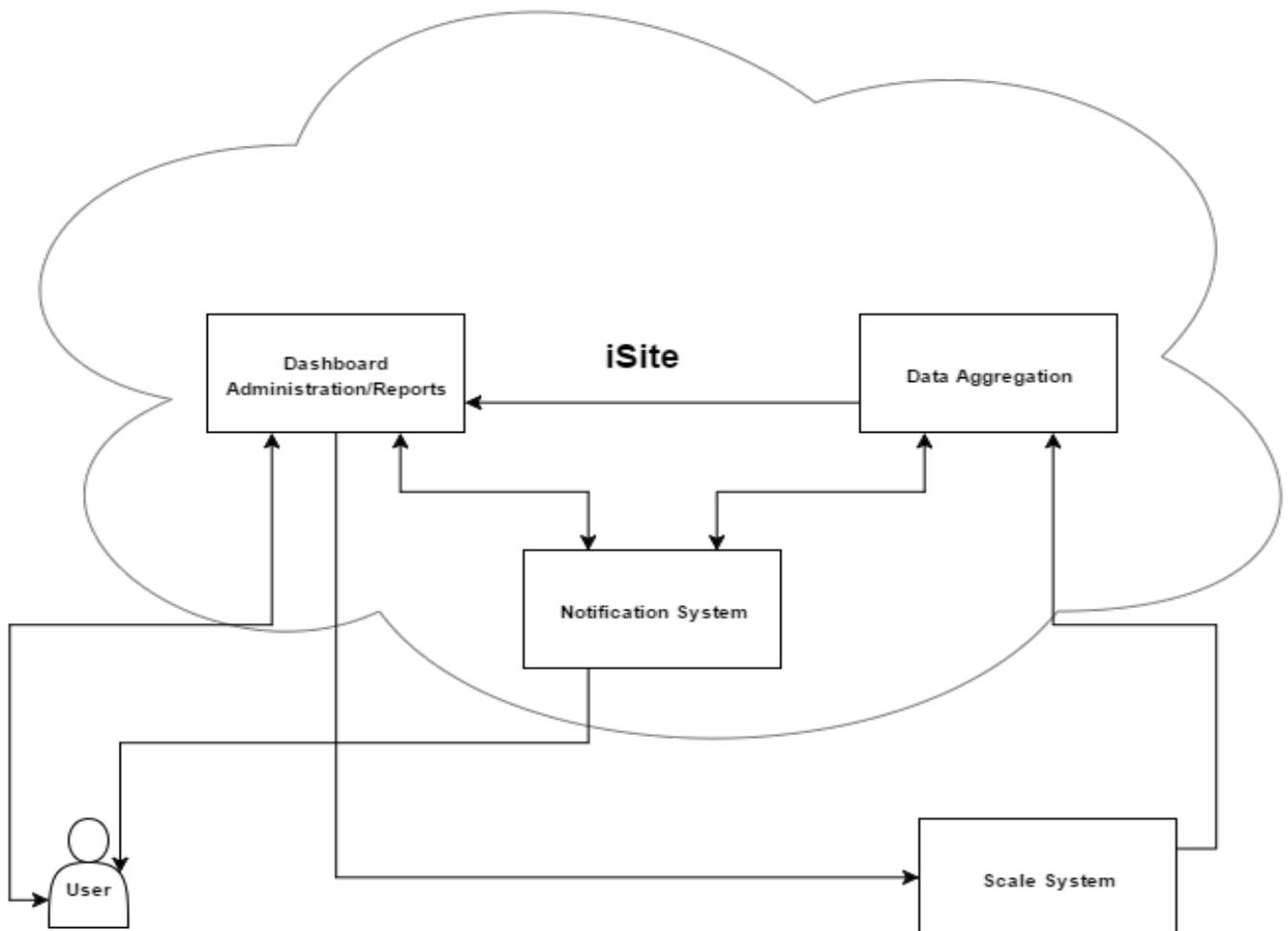
El sistema recibe información de la tarjeta de celda de carga digital dentro del indicador 225. El sistema escanea los datos del indicador, el cable de homerun, las celdas de carga y los cables de la celda de carga en busca de errores. El indicador se conecta a la nube a través de Ethernet, módem celular o a través del puente de Wi-Fi.
