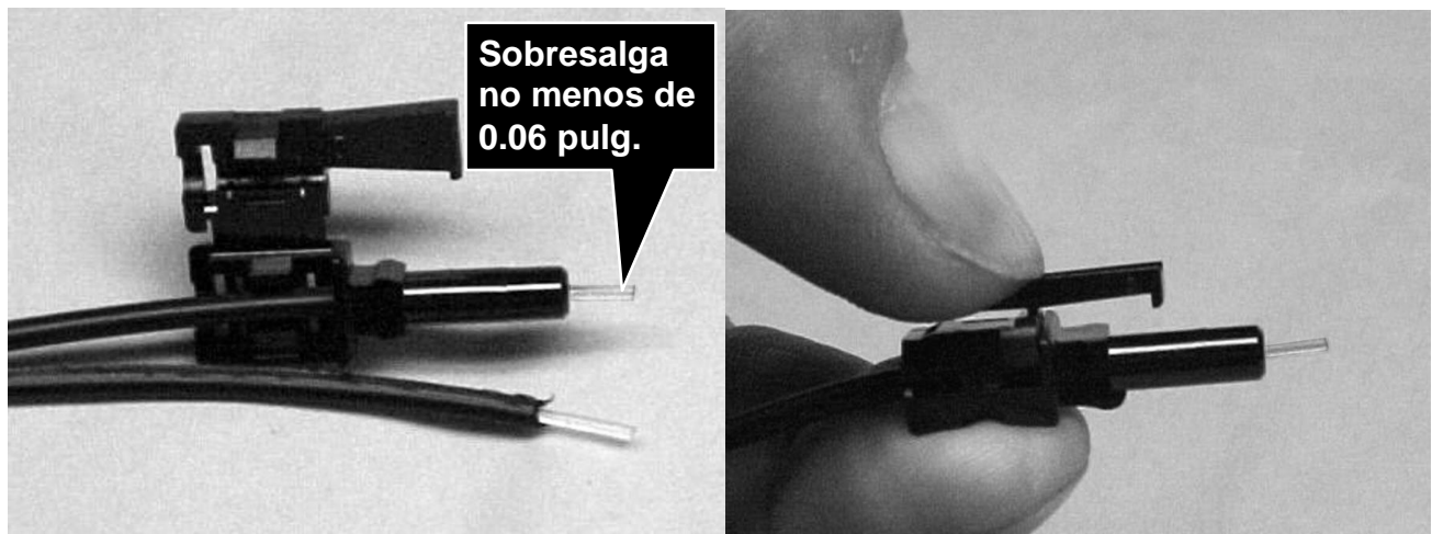
FIGURA NO. 14 CONEXIÓN DEL CONECTOR A LAS FIBRAS ÓPTICAS
