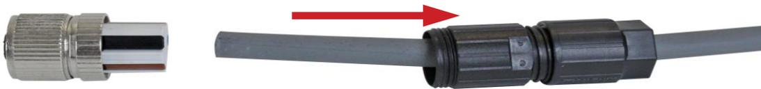
2. Con el cable de conexión directa (Homerun) guiado a través de la pieza plástica negra del conector, saque aproximadamente 1 pulgada (25 mm) de la cubierta externa de los cables, exponiendo los cables internos.
