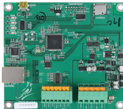
**Controlador de celda de carga digital 225DLC**
