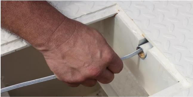
**Inserte el cable de la celda de carga en el conducto de la plataforma de peso.**
