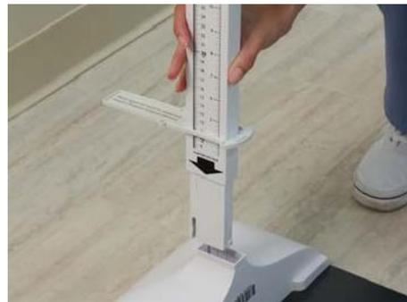
⑧ Inserte la pieza de la columna con la marca "B-C" en la pieza "A-B" y presione hacia abajo para trabarla en su lugar.
